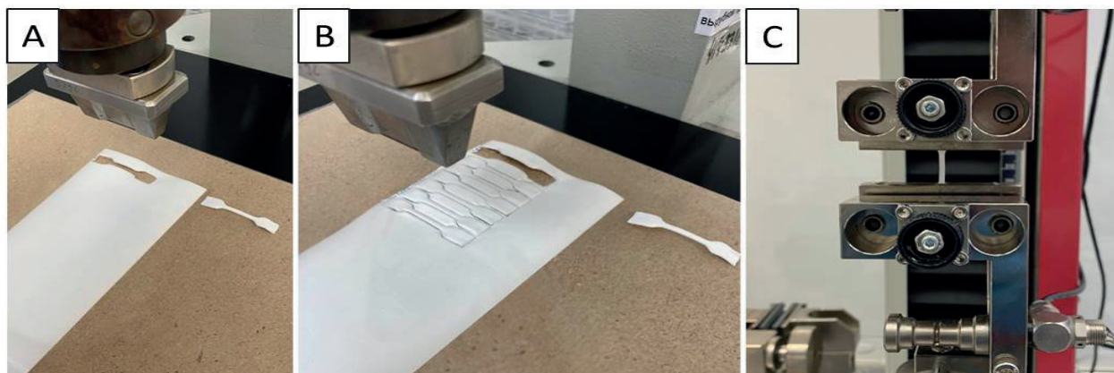
Рисунок 1. Исследование физико-механических характеристик полимерных материалов для формирования оболочки стент-графта: А – пример вырубки одного гантелеобразного испытательного образца из Политетрафторэтилена; В – то же для всей серии образцов из Политетрафторэтилена; С – пример фиксации образца в зажимах универсальной испытательной машины «Zwick/Roell»-2.5Н
